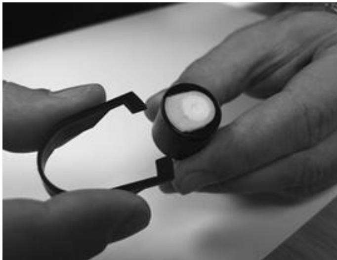
À l'aide de l'outil de retrait de la pile d'électrodes MiniPID fourni, localisez les « griffes » dans les fentes sur le côté du corps du capteur Mini PID 2.
