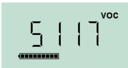
L'écran change et affiche une mesure en direct du capteur. *Ce nombre ne se rapporte pas à la concentration de gaz, il indique simplement le changement de la sortie du capteur.*
