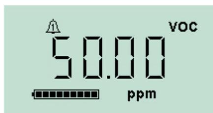
Si le niveau de gaz détecté déclenche une alarme de niveau bas, l'écran d'affichage clignote en orange et les témoins lumineux situés sur le dessus de l'appareil clignotent en rouge.
