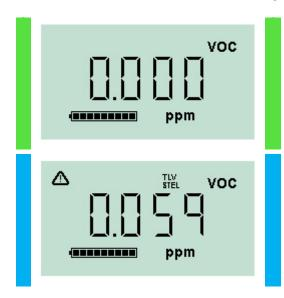
Hauptanzeigeschirm für die Gaserkennung.
