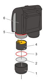
Vor der Reinigung oder dem Austausch der Lampe muss der MiniPID-Sensor entfernt werden.
