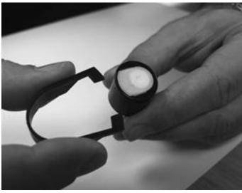
Bringen Sie die "Zacken" des mitgelieferten speziellen MiniPID-Elektrodenpaket-Ausbauwerkzeugs in die entsprechenden Schlitze an der Seite des MiniPID 2-Sensorgehäuses.
