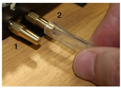
Die Null- und Kalibrierzeiten werden durch die Leitungslänge zwischen der Gasquelle und dem Kalibrierungs-Dock beeinflusst. Für beste Ergebnisse empfiehlt ION Science, die Leitungslängen auf ein Minimum zu reduzieren; je kürzer, desto weniger Gas wird benötigt.
