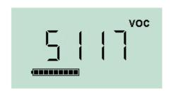
Der Bildschirm wechselt und zeigt den aktuellen Messwert des Sensors an. *Diese Zahl bezieht sich nicht auf die Gaskonzentration,* sondern weist nur darauf hin, dass der Sensorausgang sich verändert.
