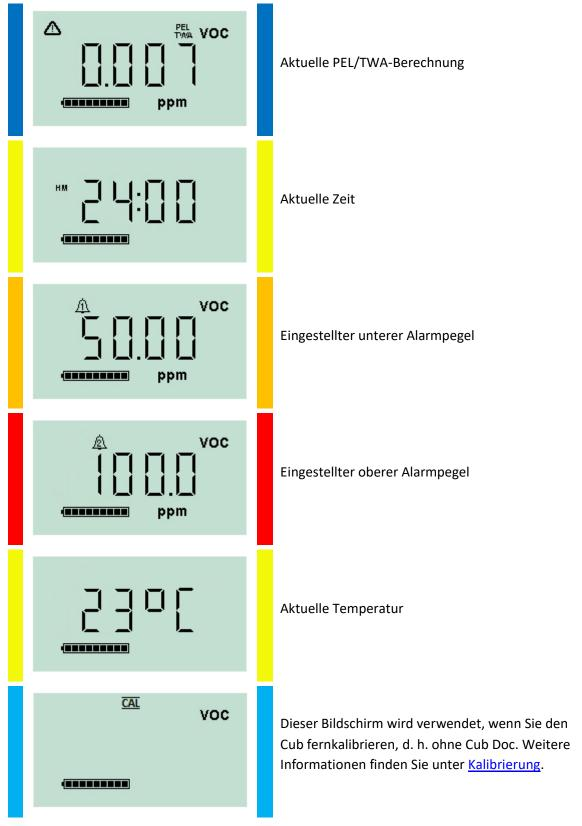
Beachten Sie, dass der Cub so konfiguriert werden kann, dass nur bestimmte Bildschirme angezeigt werden (siehe Abschnitt <u>Gerätekonfiguration</u>).
