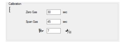
Geben Sie sowohl im Feld **Zero Gas** ("Nullgas") als auch im Feld **Span Gas** ("Prüfgas") die Anzahl der Sekunden ein, in denen das Nullgas und das Prüfgas an einen angeschlossenen Cub geschickt werden sollen, wenn er kalibriert wird.
