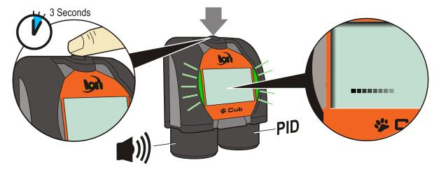
Schließlich ertönt ein kurzer Alarm, die LEDs blinken grün. Der Hauptanzeigebildschirm zur Gaserkennung (siehe unten) wird angezeigt. Der Cub ist nun einsatzbereit.
