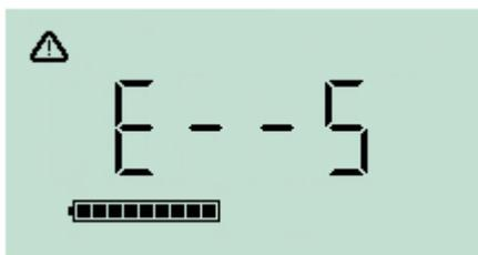
Si no existiera una diferencia significativa entre los niveles de puesta a cero y de calibración, esta se considerará fallida y la pantalla mostrará **E- - 5**. De ser así, se usarán los últimos niveles válidos de calibración.
