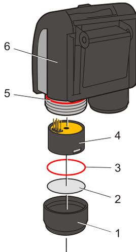
Antes de proceder a la limpieza o la sustitución de la lámpara es necesario desmontar el sensor MiniPID.
