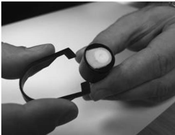
Usando la herramienta proporcionada para extraer la pila de electrodos del sensor MiniPID, localice las clavijas ubicadas en las ranuras laterales del cuerpo del sensor.
