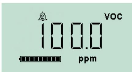
Si el gas detectado activa una alarma de nivel alto, la pantalla y las luces de la parte superior de la unidad parpadearán en rojo.
