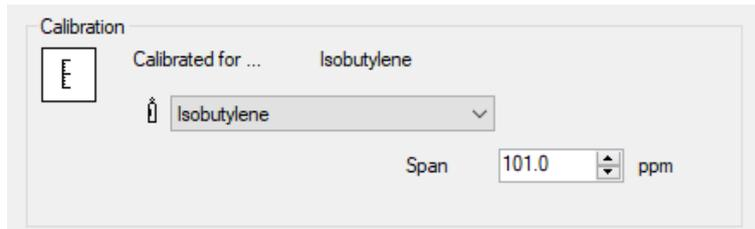
Seleccione en la lista desplegable el gas para el que se calibre el aparato.
