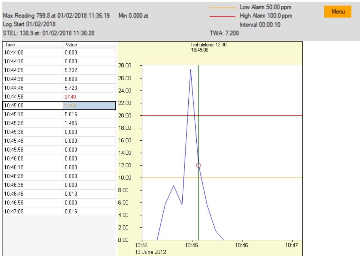
El área superior muestra los datos generales del registro y cómo estaba configurado el dispositivo Cub en ese momento.
