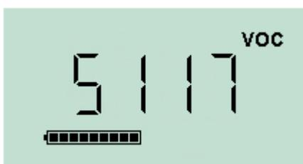
La pantalla pasará a mostrar una lectura del sensor en tiempo real. *Este número no se refiere a la concentración de gas*, simplemente indica si la salida del sensor está cambiando.
