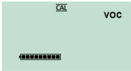
Esta pantalla se usa cuando el aparato se calibra de forma remota, sin usar una base Cub Doc. Consulte el apartado [Calibración](#) para más detalles.
