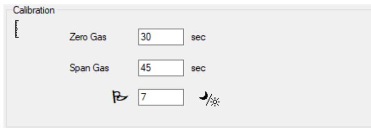
En los campos **Zero Gas** y **Span Gas**, introduzca los segundos durante los que se van a enviar, respectivamente, el gas de puesta a cero y el gas de calibración al aparato conectado durante la calibración.
