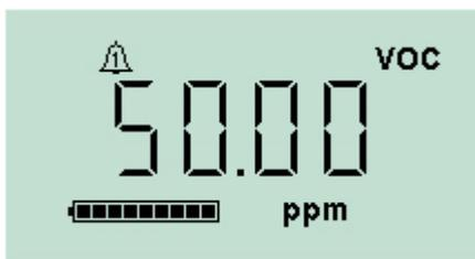
Si el gas detectado activa una alarma de nivel bajo, la pantalla parpadeará en naranja y las luces de la parte superior de la unidad parpadearán en rojo.
