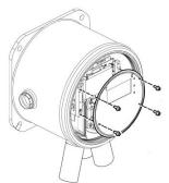
Verwenden Sie einen 2 mm Inbusschlüssel, um die vier Schrauben der Aufspannplatte zu entfernen.
