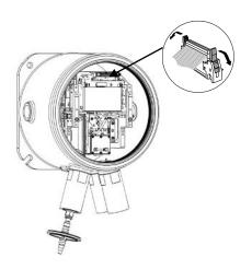
Drücken Sie die "Flügel" runter, um das Flachbandkabel an der Oberseite des Detektormoduls loszulösen.
