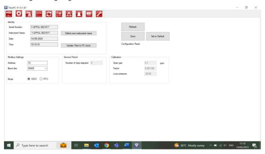
Sie können den Namen des Messgeräts zu einem aussagekräftigeren Namen ändern (zum Beispiel "Monitor Bereich 1"). Sie können Datum und Uhrzeit des Titan 2 mit der Uhr des PCs synchronisieren.
