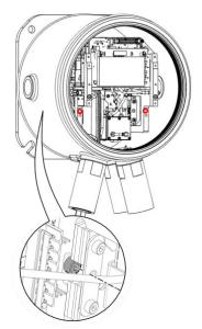
Wenn das Modul sich in der korrekten Positionierung befindet, werden die Schrauben in den Gewinden einrasten und frei drehbar sein.
