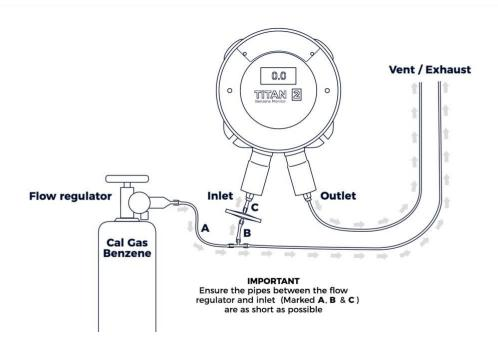
Verbinden Sie die Flasche mit dem wasserabweisenden Filter auf der Flammendurchschlagsicherung des Einlasses. Warten Sie 3 Minuten ab, bis sich die Lesung auf der Anzeige des Titan stabilisiert hat.
