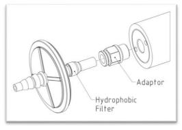
Stellen Sie sicher, dass der externe (wasserabweisende) Filter, sowie alle Abgas- und Messeinlassleitungen, angeschlossen sind.
