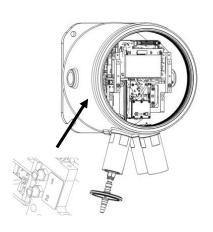
Überprüfen Sie die Kennzeichnung der pneumatischen Röhren und Konnektoren.
