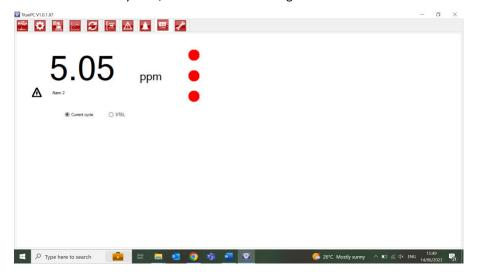
Dieses Tab spiegelt in Echtzeit wieder, was auf dem Bildschirm des Titan 2 angezeigt wird. Eine Optionsschaltfläche erlaubt dem Anwender, zwischen der aktuellen Zykluslesung und dem berechneten STEL zu wechseln.
