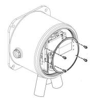
Verwenden Sie die vier Schrauben, um die Aufspannplatte anzubringen. Ziehen Sie diese handfest an.
