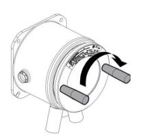
Montieren Sie den Frontdeckel. Drehen Sie dieses im Uhrzeigersinn, bis es handfest sitzt.
