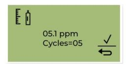
Bewegen Sie den Cursor auf den ppm-Wert. Verwenden Sie Schalter 2, um die Werte bis zur Benzolkonzentration in der Flasche durchzugehen.
