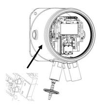
Stellen Sie sicher, dass die pneumatischen Röhren ordnungsgemäß gekennzeichnet sind, damit sie später wieder an die korrekten Konnektoren angeschlossen werden können.
