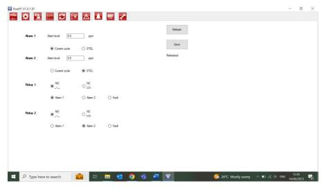
Sie können jeden Alarm so einstellen, dass er ausgelöst wird, wenn der STEL oder Benzolgehalt einen eingestellten Wert in ppm erreichen.
