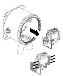
Wenn die unverlierbaren Schrauben vollständig gelöst sind, greifen Sie die Seiten des Detektormodulrahmens – wie illustriert – um ihn aus dem Gehäusemodul zu entfernen.
