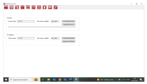
Wenn der PC mit dem Internet verbunden ist, wird TitanPC automatisch erkennen, falls eine neue Firmware- oder Softwareversion verfügbar ist.
