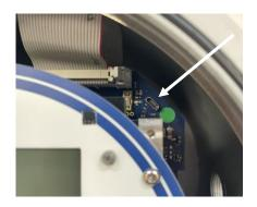
Verbinden Sie einen PC mit dem USBoder RS485-Anschluss und verwenden Sie die TitanPC Software, um das Datum und die Uhrzeit einzustellen. Lesen Sie hierzu <u>Einstellungen</u>.
