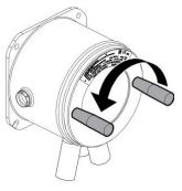
Drehen Sie es gegen den Uhrzeigersinn, um die Frontabdeckung abzuschrauben.
