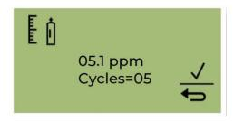
Bewegen Sie den Cursor auf den ppm-Wert. Verwenden Sie Schalter 2, um die Werte bis zur Benzolkonzentration in der Flasche durchzugehen.
