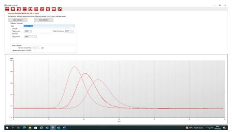
Schließen Sie eine Flasche mit einem Benzolgehalt zwischen 5 und 10 ppm an die Flammendurchschlagsicherung des Einlasses, bevor Sie mit der Kalibrierung beginnen. Dies stellt sicher, dass das Benzol vor dem Beginn der Kalibrierung durch das Titan-System fließt.
