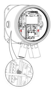
Zwei Löcher an der Vorderseite des Detektormoduls bieten Zugang zu den Schrauben.
