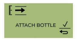
Bringen Sie die Flasche an, bevor Sie mit der Kalibrierung beginnen. Dadurch wird sichergestellt, dass vor Beginn der Kalibrierung Benzol durch das Titan 2-System fließt.
